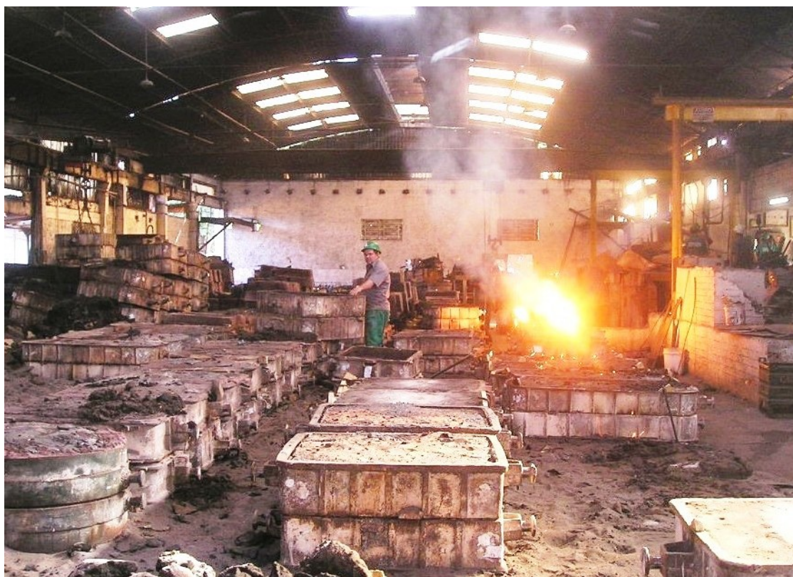
Figura 18 – Foto da aciaria. Cooperado Albertino Campos armazenando peça recém-fundida. Foto do autor.
