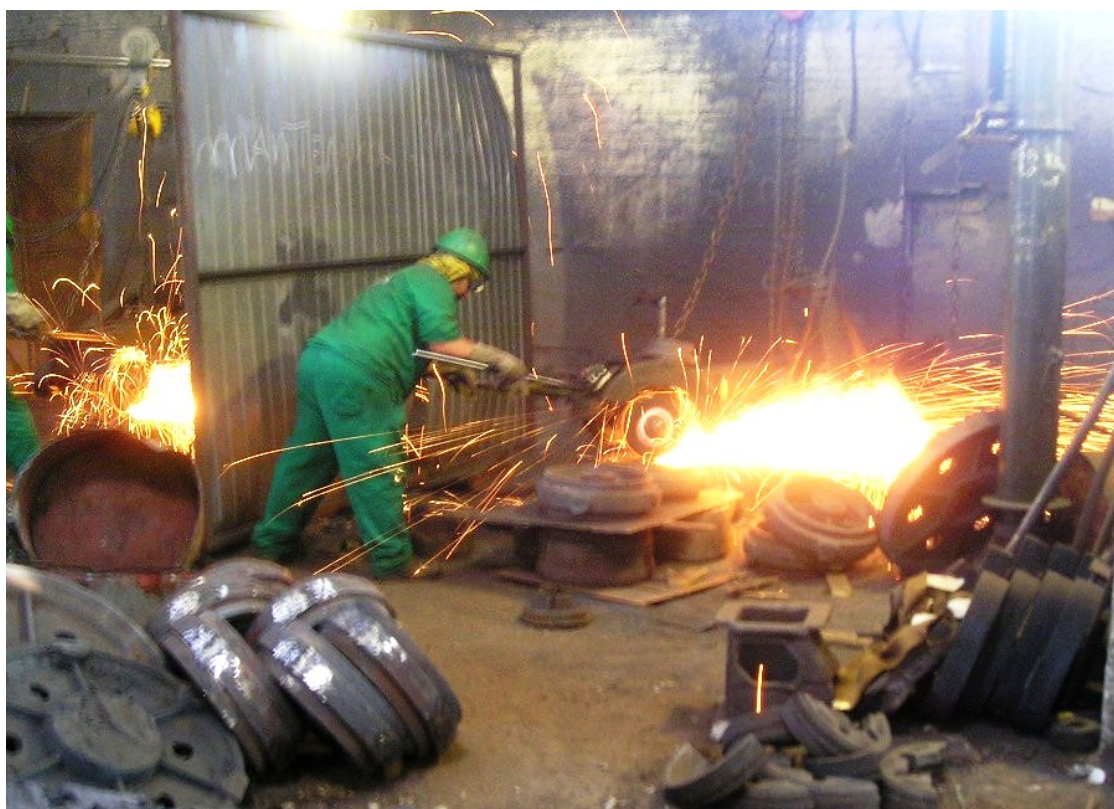
Figura 28 – Foto do rebarbamento. Foto do autor.
