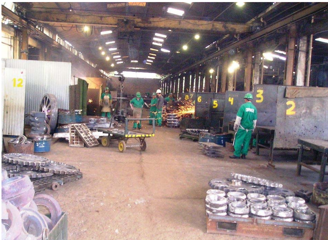
Figura 27 – Foto do rebarbamento. Foto do autor.
