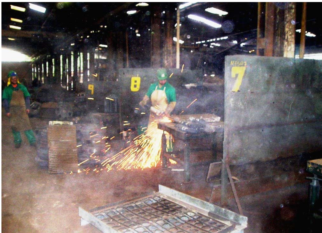
Figura 29 – Foto do rebarbamento. Foto do autor.
