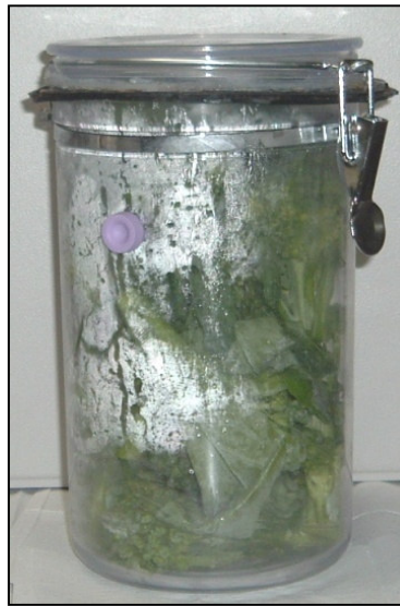
Figura 3a: Brócolis orgânicos minimamente processados acondicionados em câmara selada de acrílico com septum de borracha para coleta de gases
