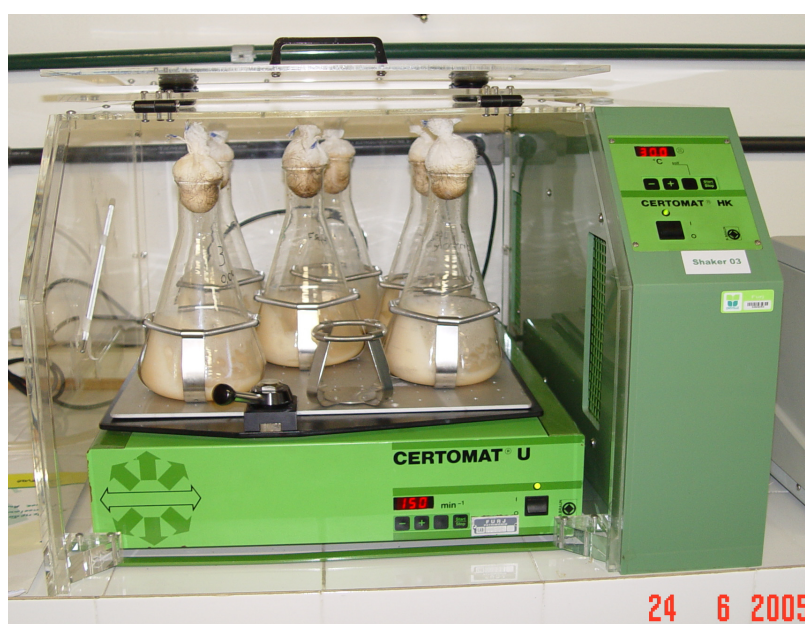
Figura 2.1: Equipamento utilizado para o cultivo de Cupriavidus necator em frascos agitados.
