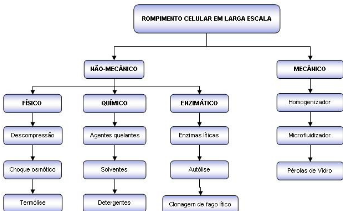
Figura 1.8: Técnicas aplicadas à ruptura celular em larga escala (MEDDELBERG, 1995).
