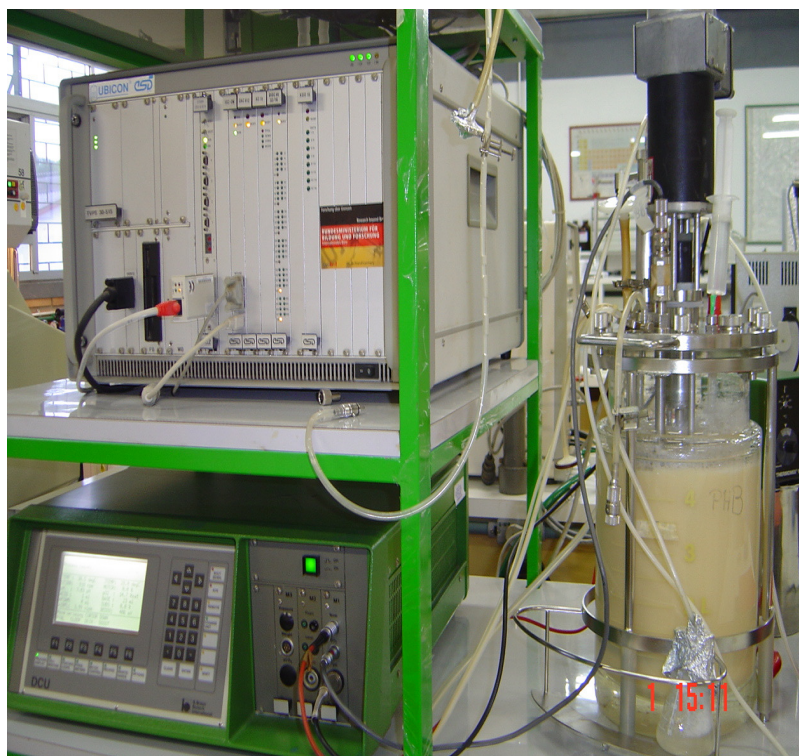
Figura 2.2: Biorreator utilizado no processo de cultivo de Cupriavidus necator .
