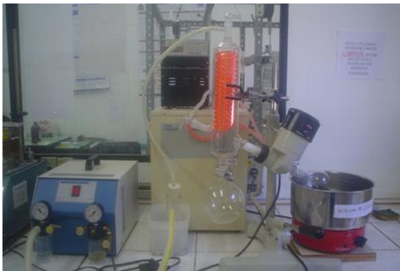
Figura 9 – Foto do rotaevaporador utilizado na ESL de óleo de bagaço de uva.
