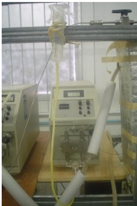
Figura 12 – Foto da bomba de co-solvente acoplada ao equipamento de ESC 1 (detalhe).
