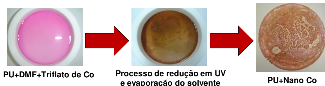
Figura A.4.4. Etapas de formação de membranas de PU incorporadas por nanopartículas de Co. Apresentando a solução de PU + DMF + Triflato de Co II, o processo de redução da nanopartícula dado pela radiação UV, por fim, a membrana de PU + Nanopartícula de Co 30%.
