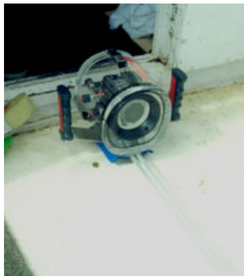
Figura 2.02 - Câmera de vídeo digital Sony® MINI DV, modelo DCR-PC 115 dentro de uma caixa
