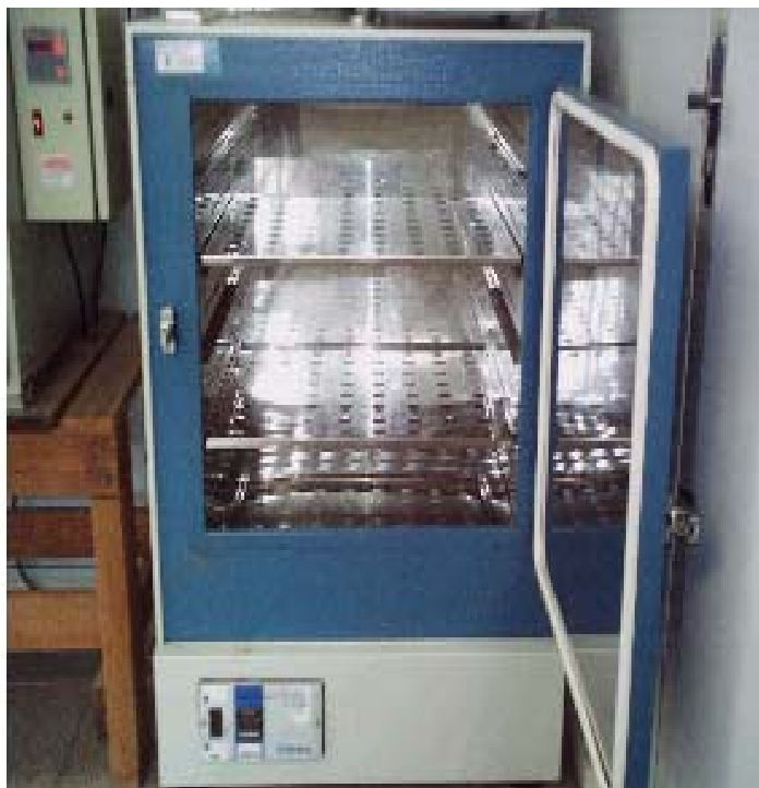
Figura 2.7 - Estufa com renovação e circulação de ar utilizada para secagem das amostras desidratadas.
