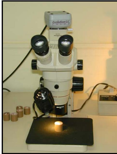
FIGURA 4.49 – Estereomicroscópio com câmera fotográfica digital acoplada.
