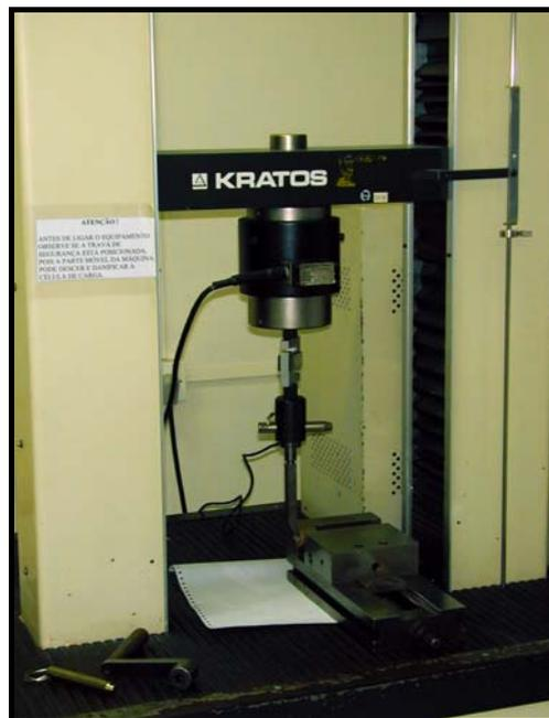
FIGURA 4.47 - Máquina de ensaios mecânicos Kratos.
