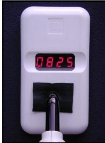
FIGURA 4.37 - Aferição do fotopolimerizador com radiômetro.
