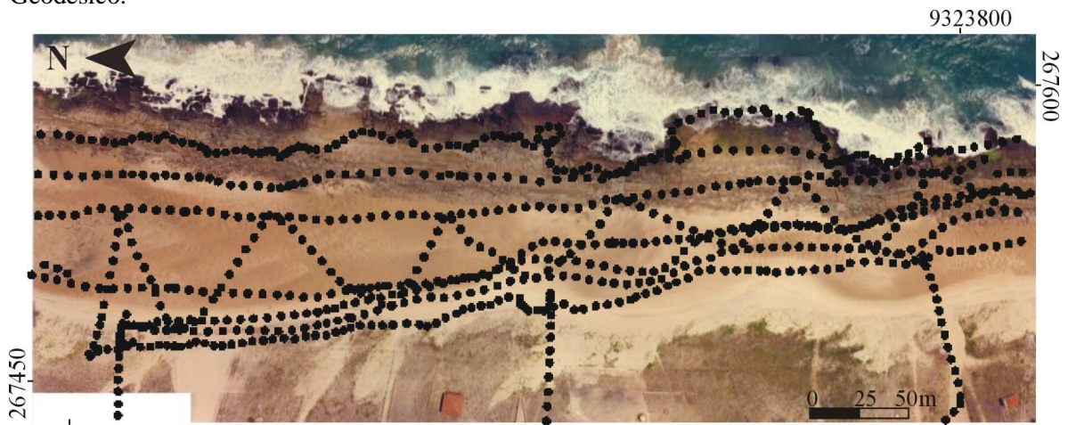
9324250 Figura 3.3 - Posição dos pontos na área de trabalho (estação 4 a 6), adquiridos com uso do GPS Geodésico.
