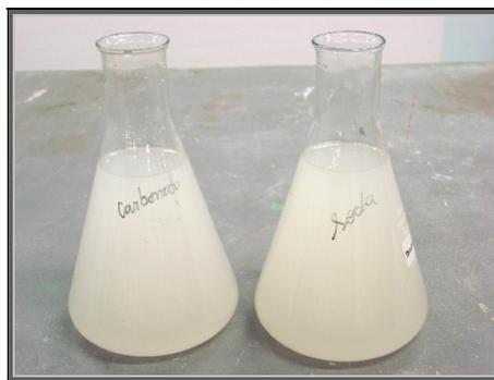
FIGURA 28 – Amostras dos licores de saída do cozimento das aparas com  $\text{Na}_2\text{CO}_3$  e  $\text{NaOH}$ .
