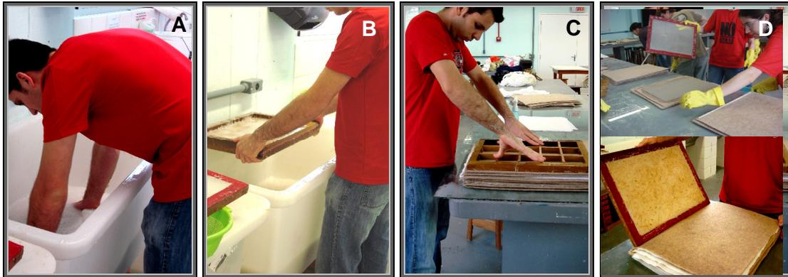
FIGURA 14 – Confeção das folhas - imersão/suspensão da tela (A), emersão da tela (B), uso de uma grade de ripas de madeira junto à forma da tela para auxiliar a transferência da folha para um suporte absorvente (C) e transferência da folha (D) - do processo de produção de papel reciclado artesanal a partir de aparas e fibras de bananeira.
