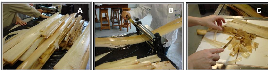
FIGURA 10 – Etapa de separação (A), maceração (B) e picotagem (C) das fibras de bananeira do processo de produção de papel reciclado artesanal a partir de aparas e fibras de bananeira.
