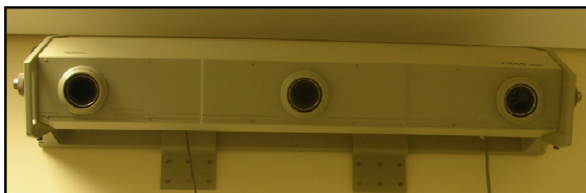
Figura 2.3. Sistema óptico tridimensional OPTOTRAK 3020, usado para captura do sinal infravermelho das marcas do ombro, cotovelo, punho e mão.
