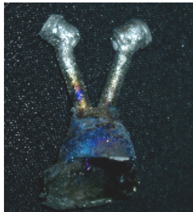
FIGURA 10- CORPOS-DE-PROVA PARA MEDIDA DE ADAPTAÇÃO APÓS FUNDIÇÃO E DESINCLUSÃO.
