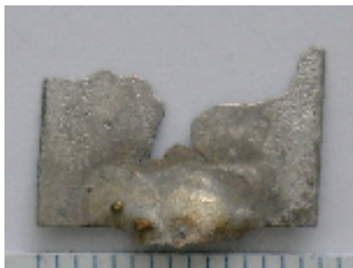
FIGURA 1B- CORPO-DE-PROVA (GRUPO CONTROLE) FOTOGRAFADO PARA ANÁLISE DA ÁREA DE FLUIDEZ
