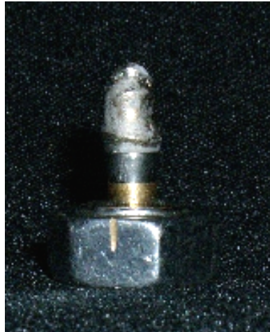
FIGURA 12- CORPO-DE-PROVA PARAFUSADO SOBRE MINIPILAR E IMPLANTE FIXADOS EM BASE METÁLICA HEXAGONAL
