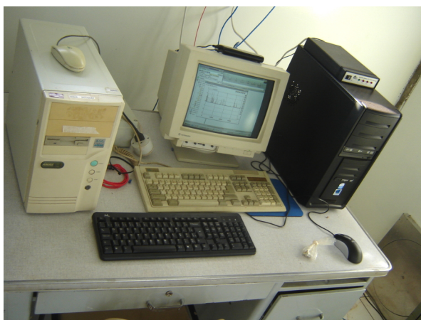
(a) A esquerda o computador de aquisição dos dados da Antena Lenta, e no monitor, pulsos de campo elétricos detectados em tempo real. A direita está a estação de coleta de dados de um sensor pertencente à rede STARNET
