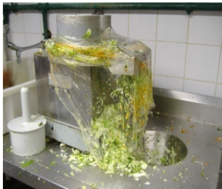
Foto 20 - Processador de vegetais com defeito
