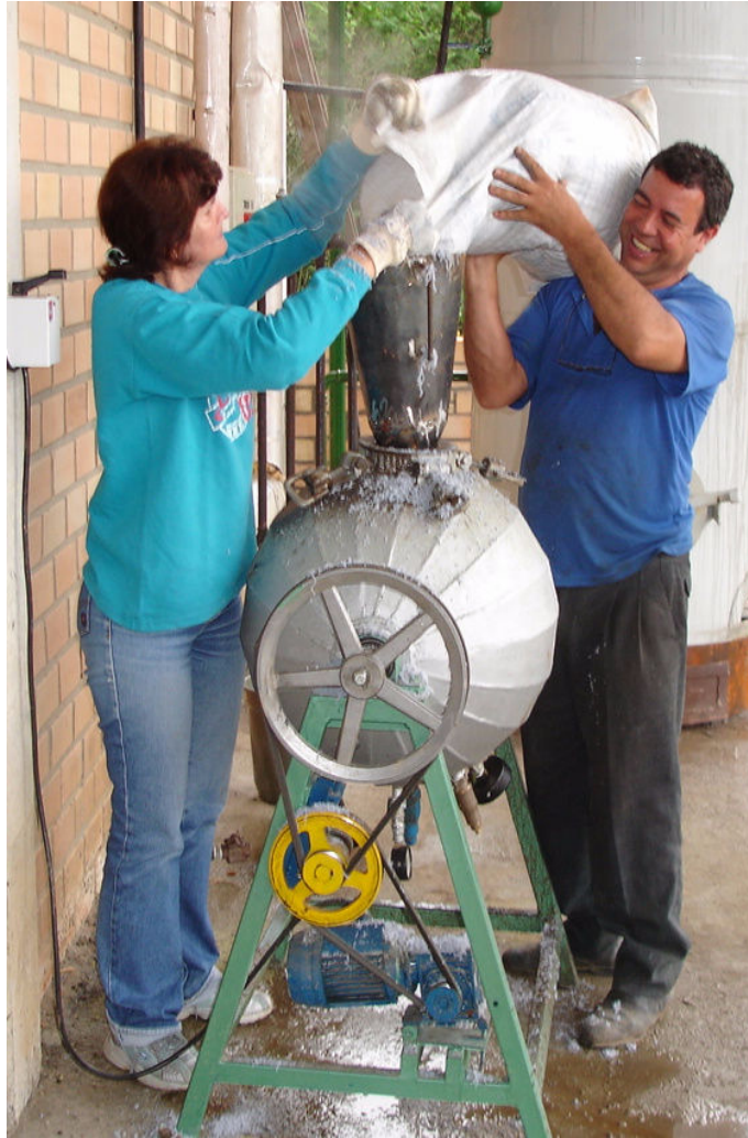
Figura 5.4: Carregamento da autoclave.
