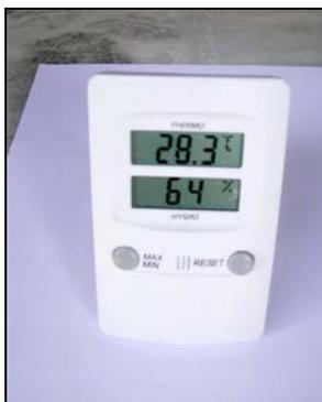
Fig.6- Termohigrômetro utilizado para medidas de temperatura umidade relativa do ar no local.
