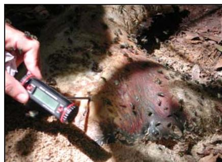
Fig. 7- Termômetro com haste de aço utilizado para medidas adicionais de temperatura no local
