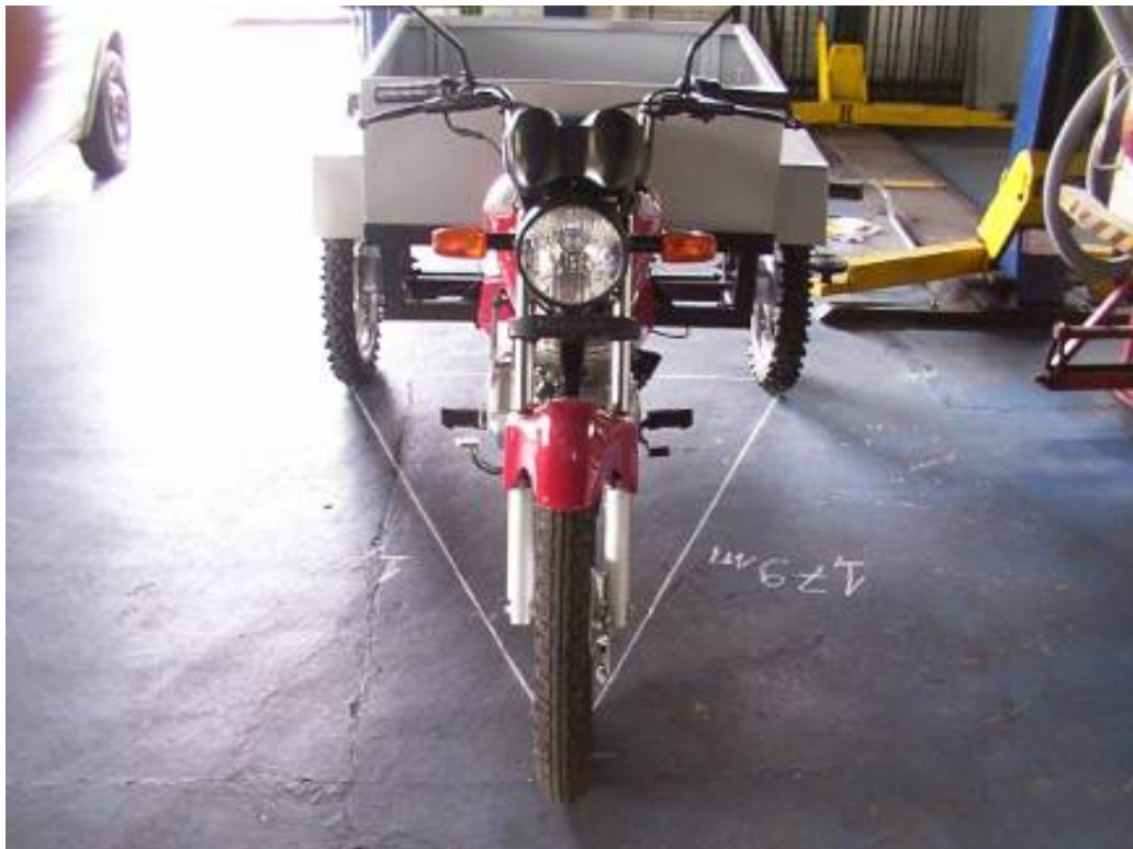
Figura 3.19 Verificação do alinhamento das rodas, CATERG.
