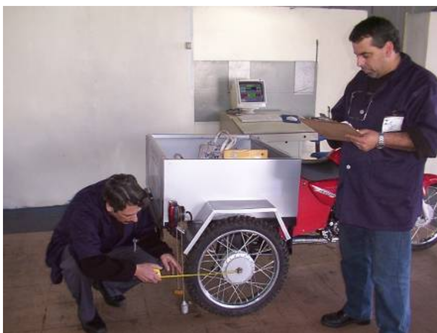
Figura 3.21 Ensaio de verificação dimensional.
