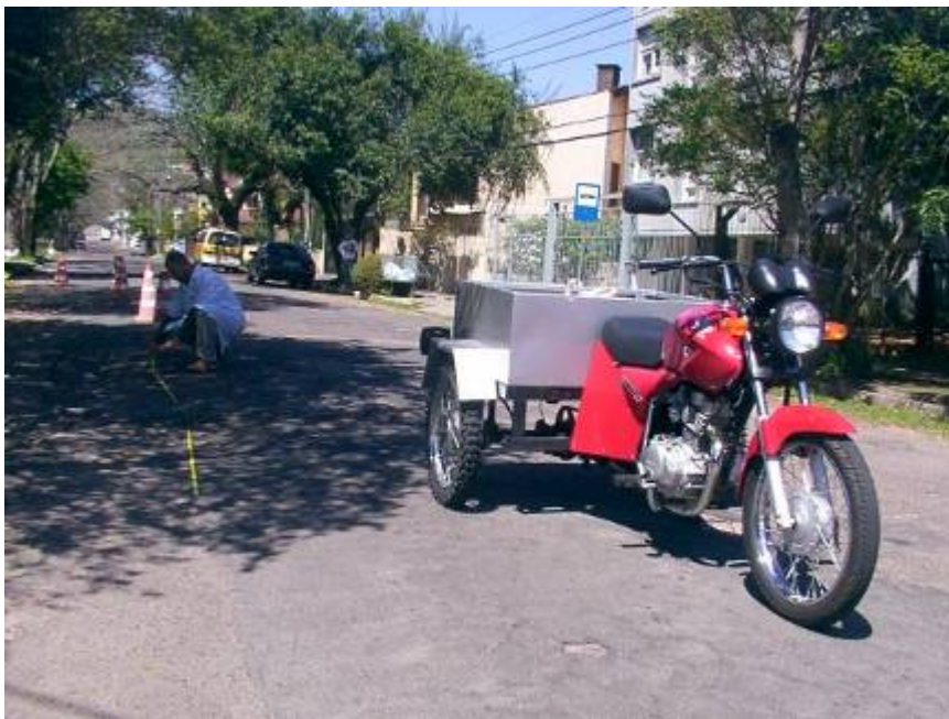
Figura 3.24 Medição da distância percorrida para frear o veículo a 80km/h.
