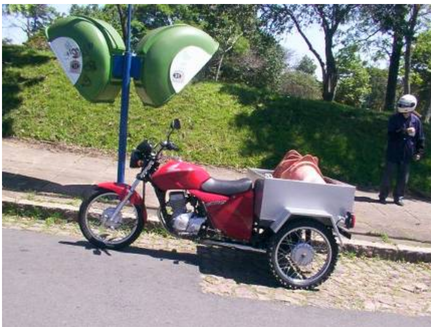
Figura 3.25 Ensaio do freio de estacionamento em rampa.
