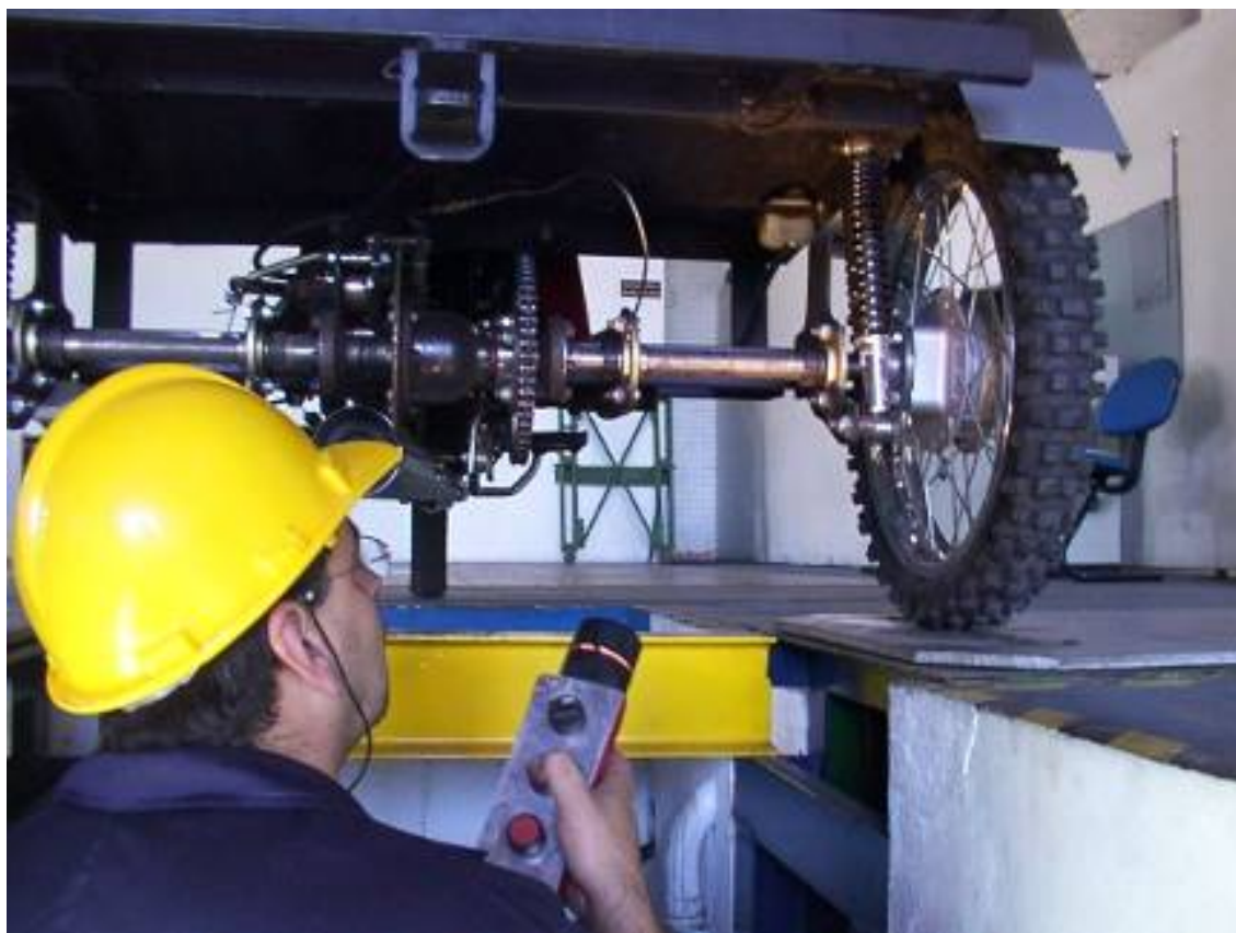
Figura 3.17 Ensaio do triciclo sobre bancada do CATERG para verificação de folgas.
