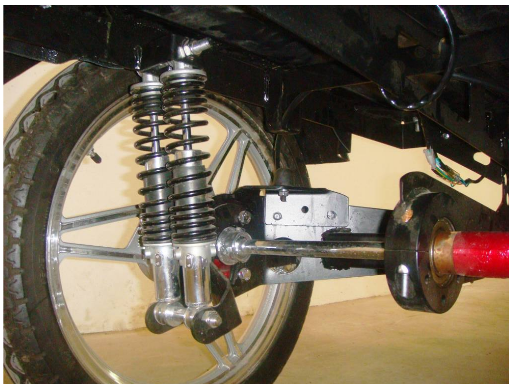
Figura 3.41 Suspensão traseira com amortecedores duplos
