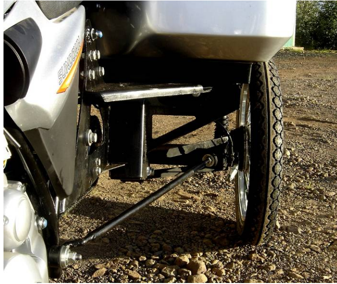
Figura 3.55 Barra estabilizadora para aumentar rigidez do chassi.
