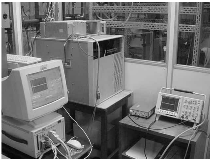
Figura 3.10: Sistema de controle e aquisição de dados - equipamento ultra-sônico.
