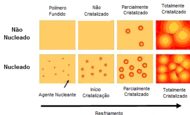
Figura 1 - Representação do processo de cristalização de uma matriz polimérica na ausência e na presença de agente nucleante [34] .
