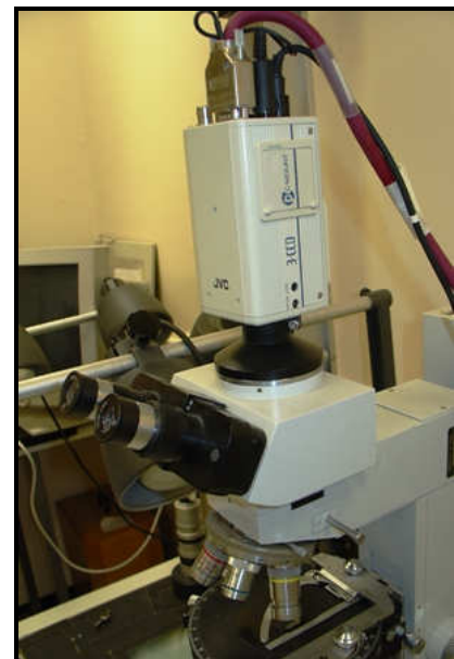
d. Câmara de vídeo (JVC 3-CCD) acoplada ao microscópio, utilizada na captura das imagens das secções de biofilme.
