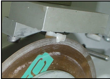
a. Corte da face vestibular de um molar, utilizando disco diamantado em uma cortadeira automática (Isomet, Buehler).
