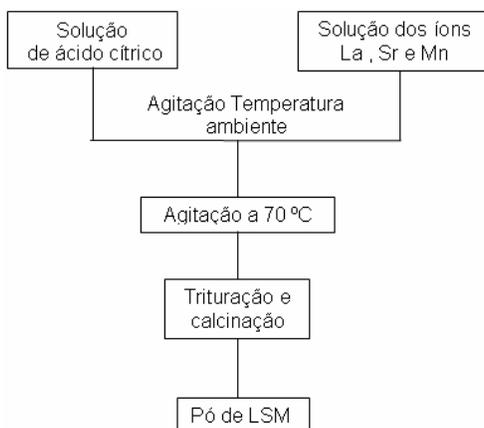
Figura 2.1. Diagrama da síntese do LSM via citrato.
