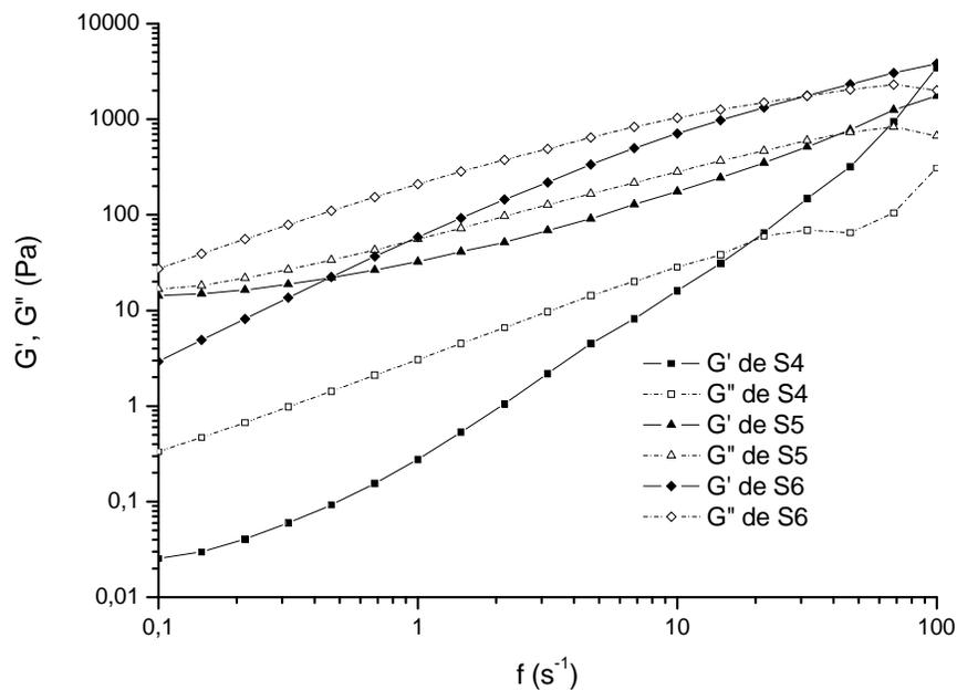
Figura 4.7. Testes de oscilação em função da amplitude de frequência para as suspensões com diferentes quantidades de dispersante (S4, S5 e S6). Os termos  $G'$  e  $G''$  são os módulos de armazenamento e de perda, respectivamente.
