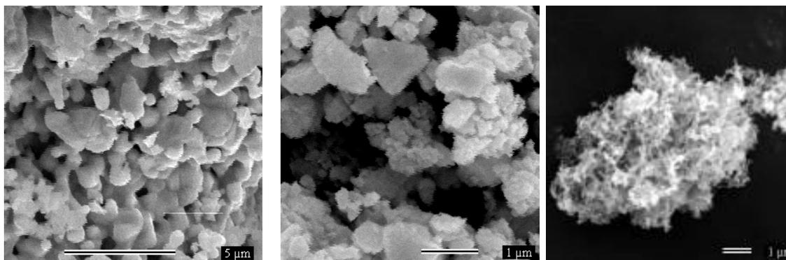
Figura 3.4. Imagens de MEV dos pós de LSM. a)  $\text{La}_{0,8}\text{Sr}_{0,2}\text{MnO}_3$  citrato; b)  $(\text{La}_{0,8}\text{Sr}_{0,2})\text{MnO}_3$  citrato e c)  $\text{La}_{0,8}\text{Sr}_{0,2}\text{MnO}_3$  pechini.
