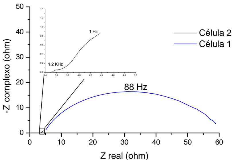
Figura 5.1. Diagramas de impedância para as Células 1 e 2.
