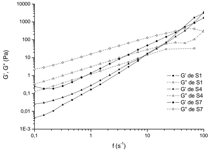
Figura 4.9. Testes de oscilação em função da amplitude de frequência para as suspensões com diferentes frações volumétricas de pó (S1, S4 e S7). Os termos  $G'$  e  $G''$  são os módulos de armazenamento e de perda, respectivamente.
