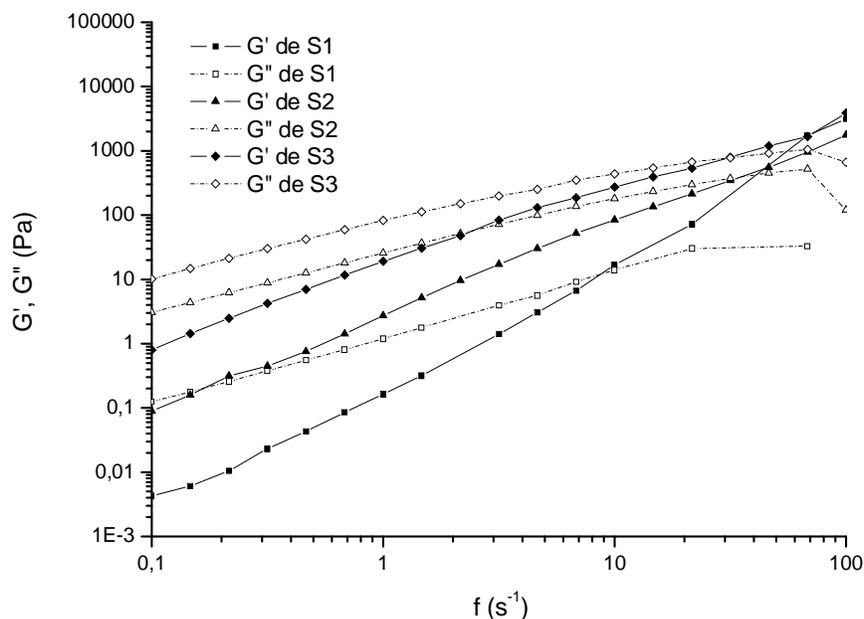
Figura 4.6. Testes de oscilação em função da amplitude de frequência para as suspensões com diferentes quantidades de dispersante (S1, S2 e S3). Os termos  $G'$  e  $G''$  são os módulos de armazenamento e de perda, respectivamente.
