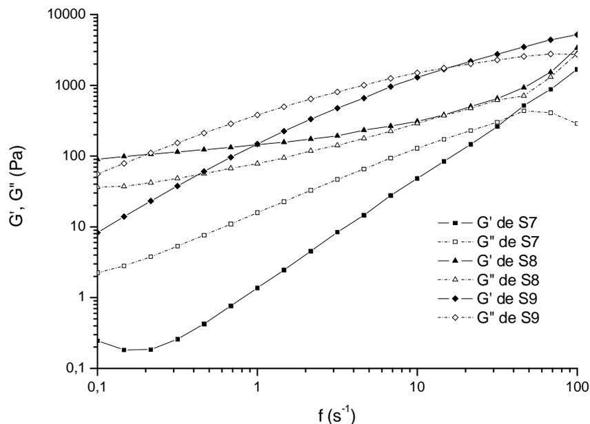
Figura 4.8. Testes de oscilação em função da amplitude de frequência para as suspensões com diferentes quantidades de dispersante (S7, S8 e S9). Os termos  $G'$  e  $G''$  são os módulos de armazenamento e de perda, respectivamente.
