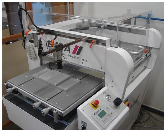
Figura 2.4. Equipamento utilizado na deposição por serigrafia.
