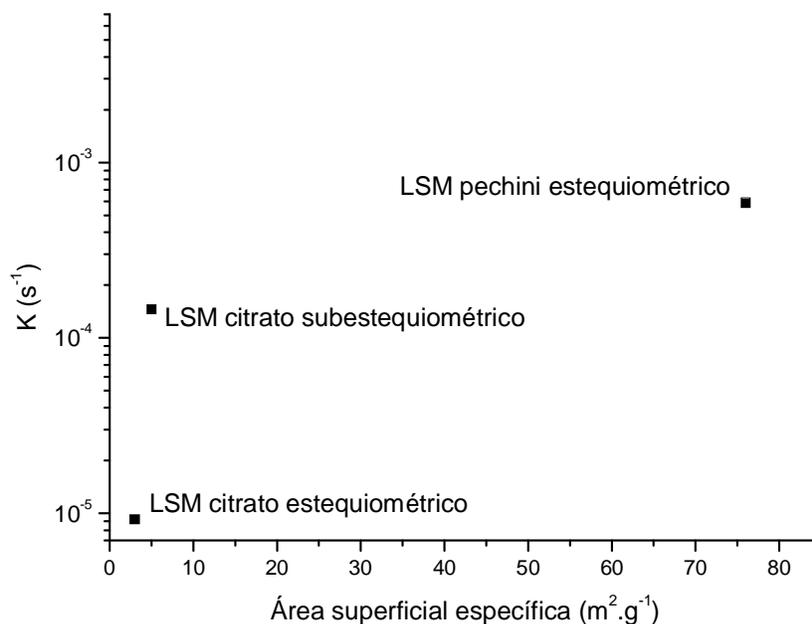
Figura 3.6. Constante cinética da reação de decomposição de H<sub>2</sub>O<sub>2</sub> em função da área superficial específica.
