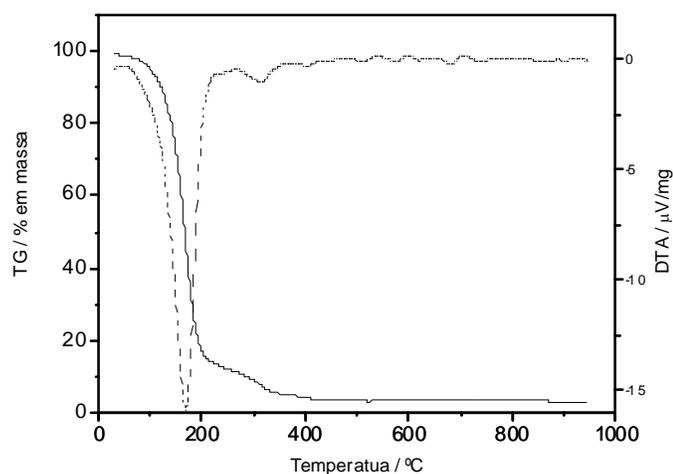
Figura 3.7. Análise térmica do veículo etilcelulose + terpineol.
