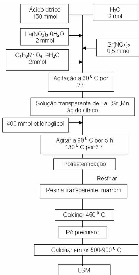
Figura 2.2. Diagrama da síntese do LSM via Pechini.
