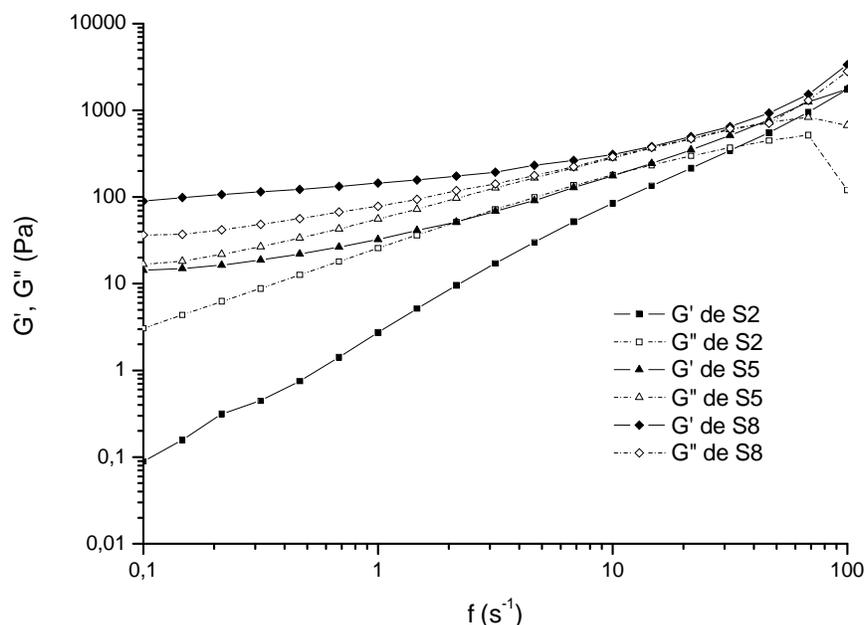
Figura 4.10. Testes de oscilação em função da amplitude de frequência para as suspensões com diferentes frações volumétricas de pó (S2, S5 e S8). Os termos  $G'$  e  $G''$  são os módulos de armazenamento e de perda, respectivamente.
