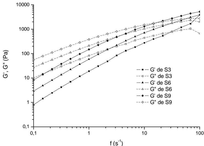
Figura 4.11. Testes de oscilação em função da amplitude de frequência para as suspensões com diferentes frações volumétricas de pó (S3, S6 e S9). Os termos  $G'$  e  $G''$  são os módulos de armazenamento e de perda, respectivamente.
