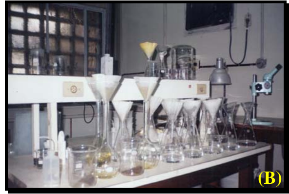
Figura 2.9 - (A) Sedimentos arenosos e lamosos colocados em becker de 500 e 1000 ml e lavados com água, para a dissolução do sal, para serem colocados na estufa a uma temperatura de 60°, para secagem; (B) Amostra atacada com HCl diluído a 10% e peróxido de hidrogênio e (C) Análise granulométrica no granulômetro à laser modelo 1180L da CILAS (Fotos: Frazão, nov. 2002).
