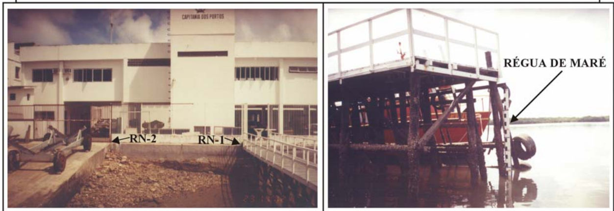
Figura 2.10 - Diagrama de nivelamento da estação maregráfica da Capitania dos Portos do Rio Grande do Norte (CPRN).
