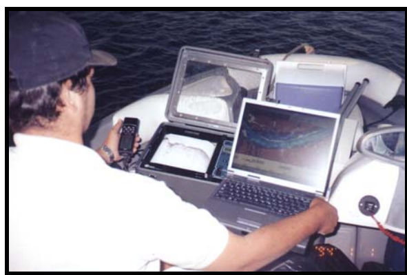
Figura 2.5 - Navegação em tempo real mediante o software GPS TrackMaker v.3.3.1 possibilitando a visualização da trajetória da embarcação na tela do notebook (Fotos: Frazão, jan. 2002).
