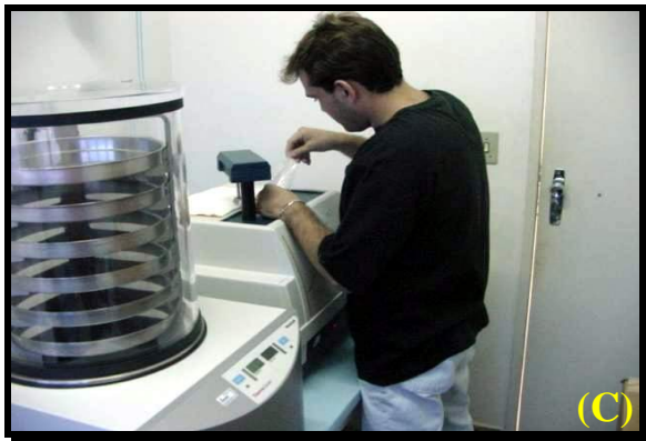
Figura 2.9 - (A) Sedimentos arenosos e lamosos colocados em becker de 500 e 1000 ml e lavados com água, para a dissolução do sal, para serem colocados na estufa a uma temperatura de 60°, para secagem; (B) Amostra atacada com HCl diluído a 10% e peróxido de hidrogênio e (C) Análise granulométrica no granulômetro à laser modelo 1180L da CILAS (Fotos: Frazão, nov. 2002).
