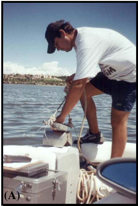
Figura 2.8 - Coleta das amostras de fundo do estuário do rio Potengi com o amostrador pontual do tipo van veen (A) e esquema do sistema de coleta com o amostrador pontual do tipo van veen (B) (Foto: Frazão, mar. 2002).
