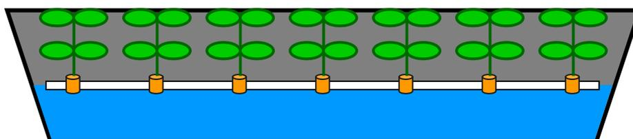
**Figura 2: Sistema de aclimatização de plântulas de morangueiro em bandejas não alveoladas com uma placa de poliestireno flutuante na solução nutritiva.**
