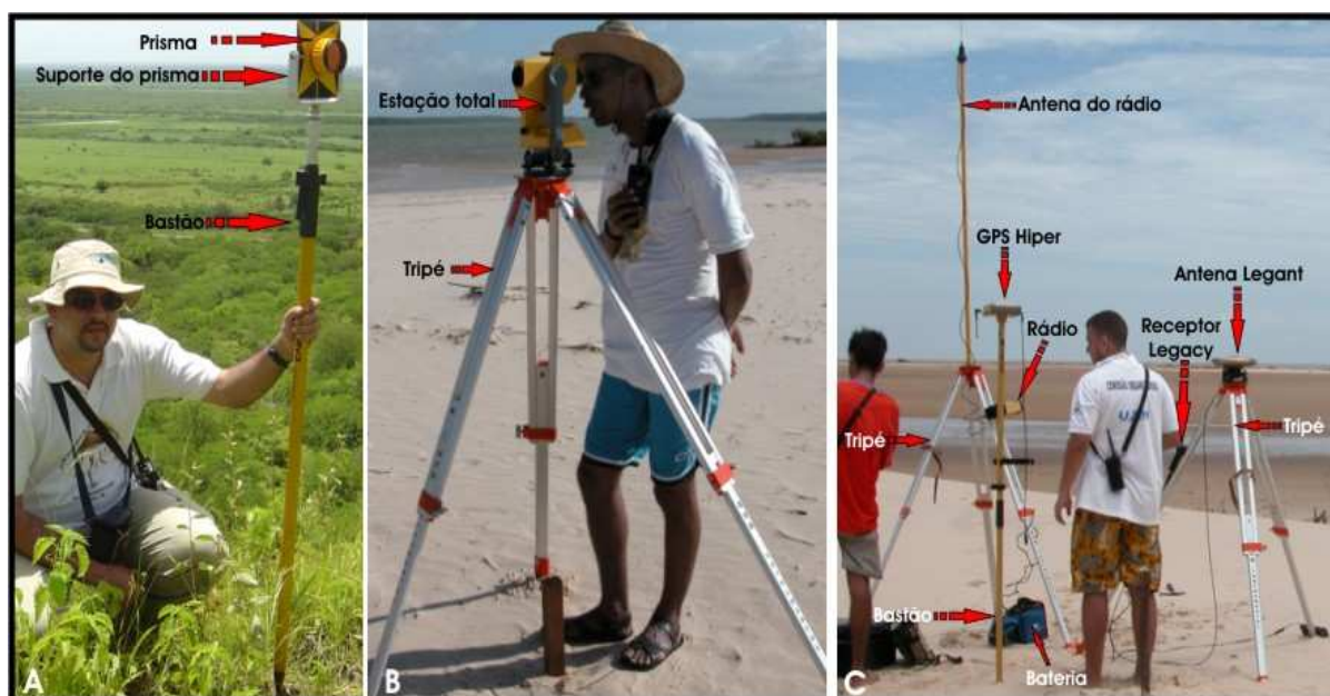
Figura 2.4- Equipamentos empregados nos levantamentos plani-almétricos. A-Bastão e prisma da Estação Total. B-Estação Total Trimble 3305 DR e tripé. C-GPS Geodésico, Hiper – RTK da marca Topcon .
