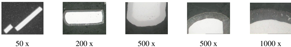
Figura 21 – Porosidade da camada nitretada a diferentes ampliações.
