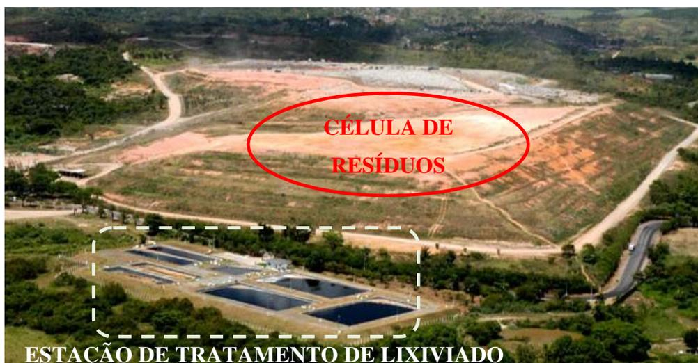
**FIGURA 14.** Vista aérea da célula de resíduos e da estação de tratamento de lixiviado do Aterro da Muribeca (2007).
