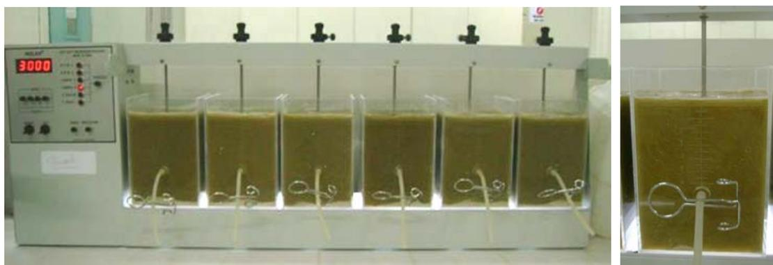
**FIGURA 18.** Tratamento do Lixiviado Bruto (L1) com  $(\text{Ca}(\text{OH})_2)$  (35g/l) no Jar Test.
