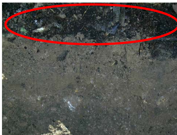
FIGURA 1 Foto de um perfil de coleta de amostras de solo. Circulado em vermelho, horizonte A em formação; logo abaixo, horizonte intermediário.
