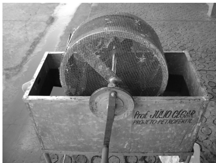
FIGURA 2 Máquina utilizado no processo de lavagem dos sacos
