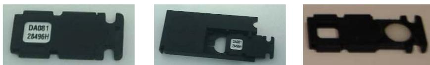
**Figura 1.1.** Dosímetro OSL estudado. Em destaque: sensibilidade 0,81 indicada pelo fabricante e identificação alfanumérica 28496H; adaptador utilizado no ato da leitura do dosímetro; dosímetro OSL aberto expondo o  $\text{Al}_2\text{O}_3:\text{C}$ , estado em que permanece dentro da leitora para que o estímulo óptico seja possível.
