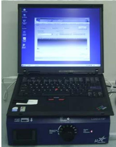
**Figura 1.2.** Sistema dosimétrico *microStar*<sup>®</sup> estudado: composto pela leitora *microStar*<sup>®</sup> da empresa Landauer e computador contendo *software* de leitura. Esta figura mostra a gaveta em que o dosímetro OSL é inserido para leitura. Além do seletor, disco metálico que parti da posição de não-leitura para a posição de leitura.
