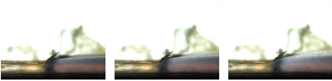
Figura 6.2: Interseção acrílico/cobre para t = 0s, 5s, 5min, 10min, 20min e 30min .
