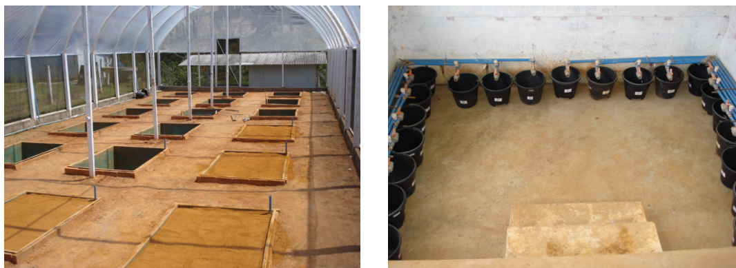
Figura 1 – Visão geral da área experimental, em fase de preenchimento, mostrando, à esquerda, os lisímetros e, à direita, a estação de coleta de efluente sob abrigo.
