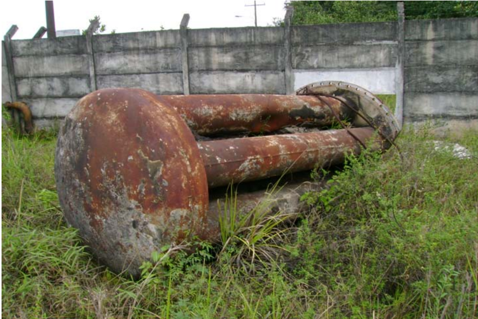
Figura 3.1 – Fotografia de parte de um tratador de óleo
