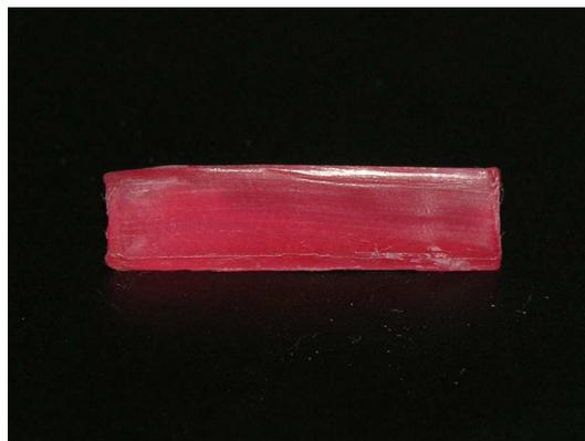
Fig 1: Padrão em cera 7 com 20 mm de comprimento, 5 mm de largura e 2 mm de espessura.
