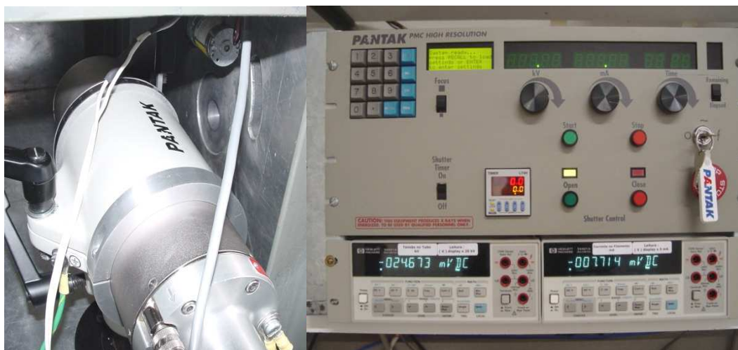
Figura 3.1: Tubo de raios X e painel de controle do equipamento de raios X Pantak, modelo HF 160.
