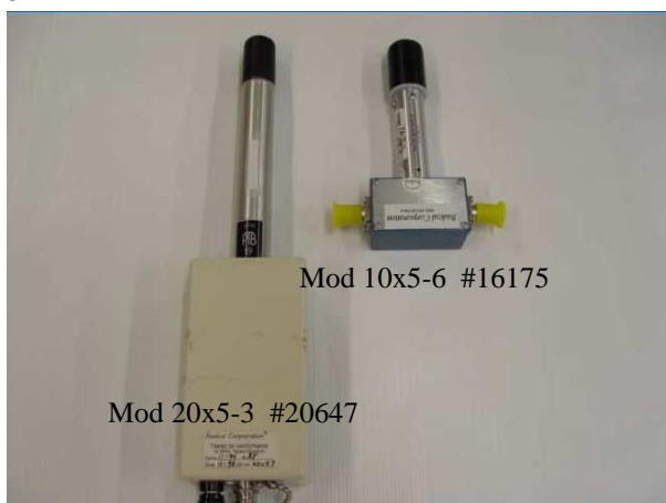
Figura 3.4: Câmaras de ionização da Radcal Corporation para radiodiagnóstico convencional
