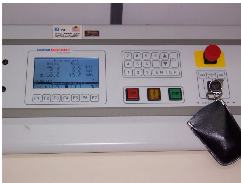
Figura 3.3: Painel de controle do equipamento de raios X Pantak/Seifert, modelo ISOVOLT 320/13 HS.
