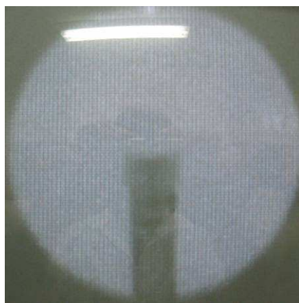
Figura 4.13: Verificação da centralização da câmara no campo de radiação
