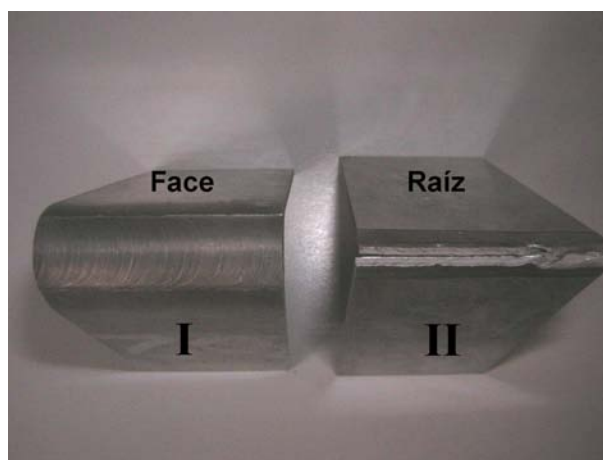
Figura 5.6. Resultado dos ensaios de dobramento para a liga AA2024-T3 (lado de avanço) e AA7075-T6 (lado de recuo).
