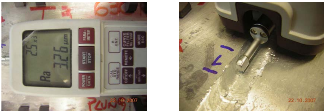
Figura 4.12. Medição da rugosidade média ( R_a ) da superfície superior do cordão de solda.
