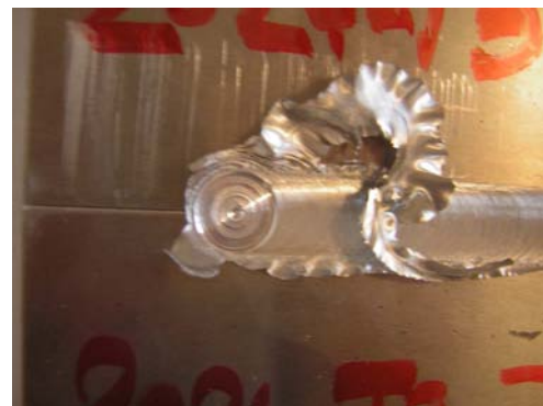
Figura 4.8. Soldas com excessiva rebarba o que evidencia que o pino está muito curto.
