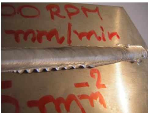
Figura 4.8. Soldas com excessiva rebarba o que evidencia que o pino está muito curto.
