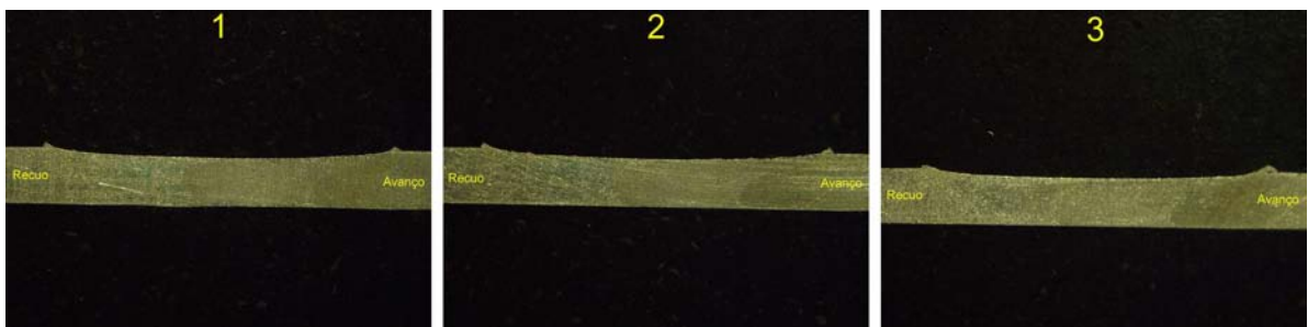
Figura 5.3. Seção transversal da solda utilizando a liga AA7075-T6 no lado de recuo e a liga AA2024-T3 no lado de avanço.
