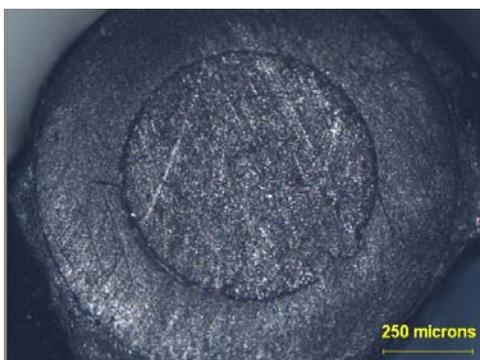
**Figura 3.24.** Imagem ampliada cinco vezes do microdispositivo contendo ET de compósito de grafite na composição otimizada (circunferência interna). A circunferência externa é a ponta de micropipeta.
