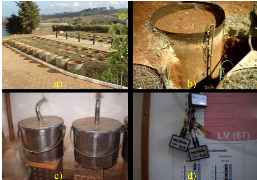
FIGURA 13. Vista parcial da bateria de lisímetros (a), montagem dos sensores de umidade do solo (b), detalhe do recipiente de coleta da água percolada (c) e dos dispositivos de armazenamento de dados de tensão de água no solo ( data loggers ) (d).
