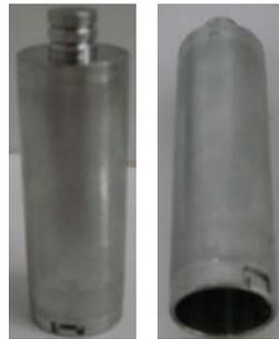
**Figura 3.21-** Porta-amostra utilizado no viscosímetro Brookfield- DVII
