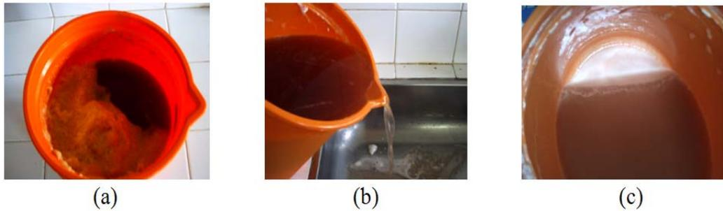
**Figura 3.10-** Descarte do sobrenadante após a primeira decantação: (a) parte da mucilagem presente nos tubérculos, (b) descarte da solução de NaOH juntamente com a mucilagem e (c) precipitado decantado (amido) no recipiente
