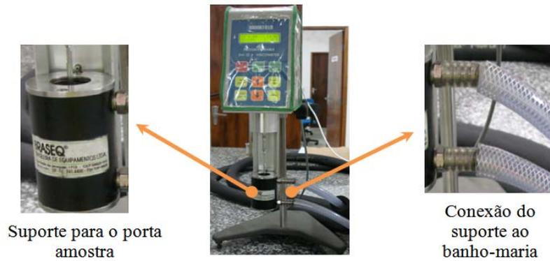
**Figura 3.20-** Viscosímetro Brookfield- DVII
