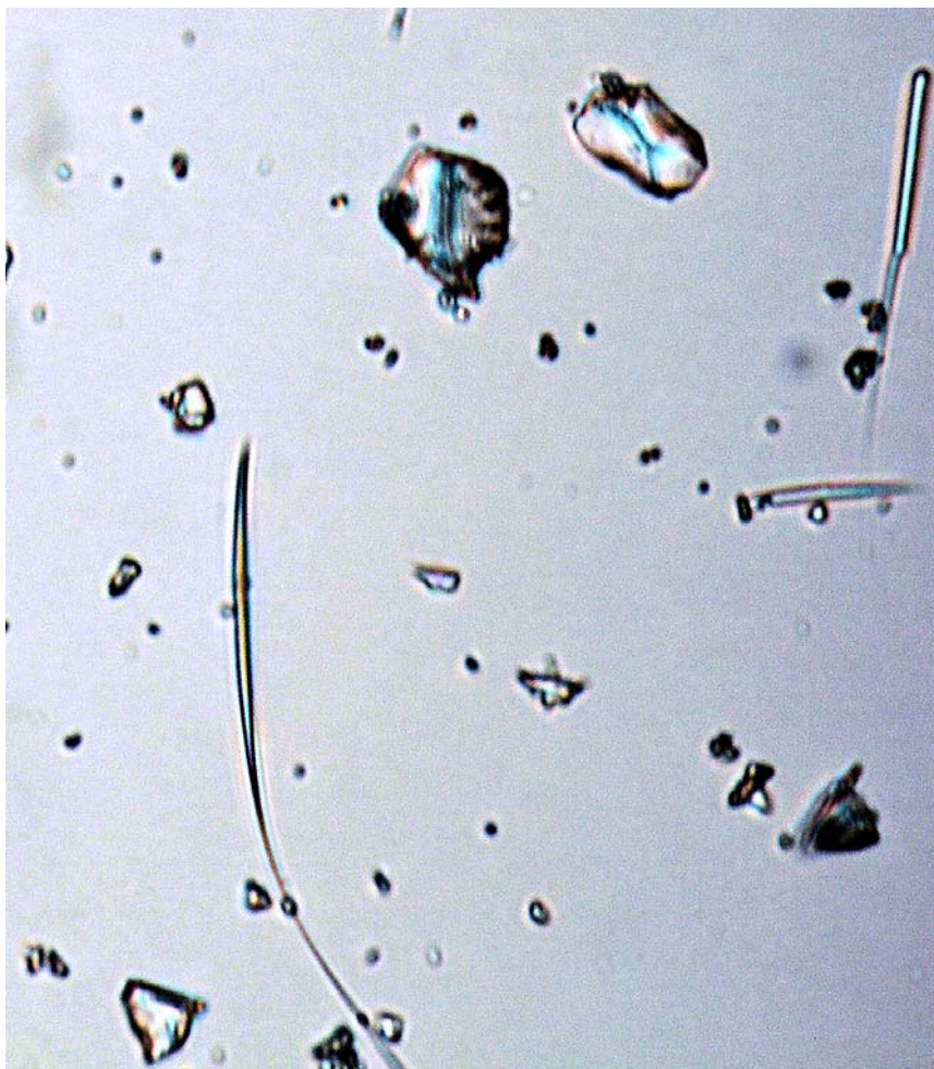
Figura 73 – Micrografia óptica de transmissão da amostra SF, indicando a presença de fibras de diversas formas e tamanhos. Ampliação de 20 X.
