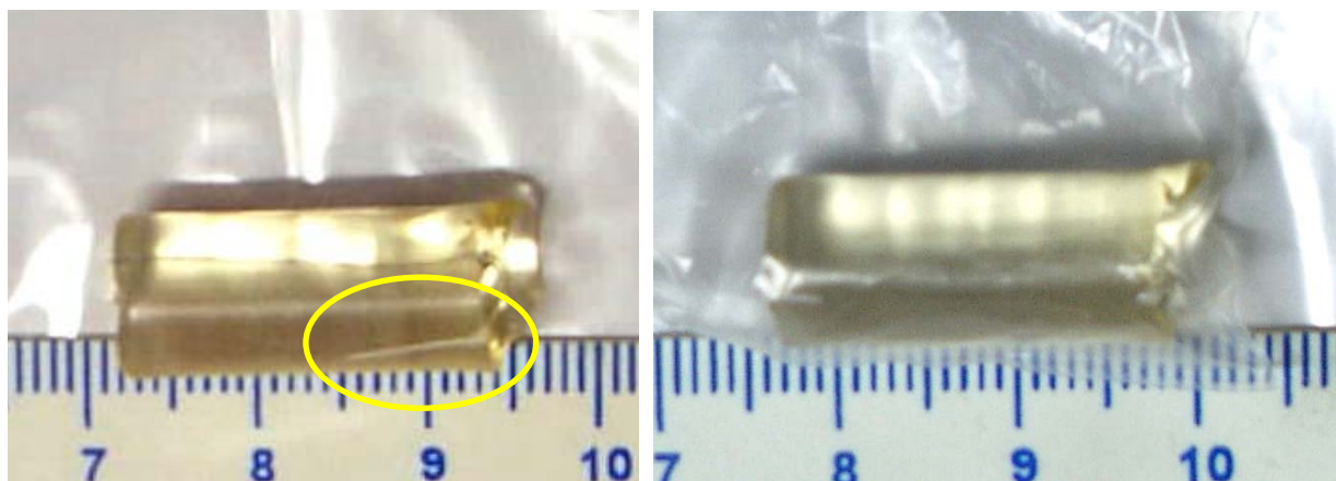
Figura 52 – Fotos da trinca e do xerogel regenerado da amostra 10F1, respectivamente. Em detalhe a indicação da trinca ocasionada em 10 segundos de exposição ao ar.
