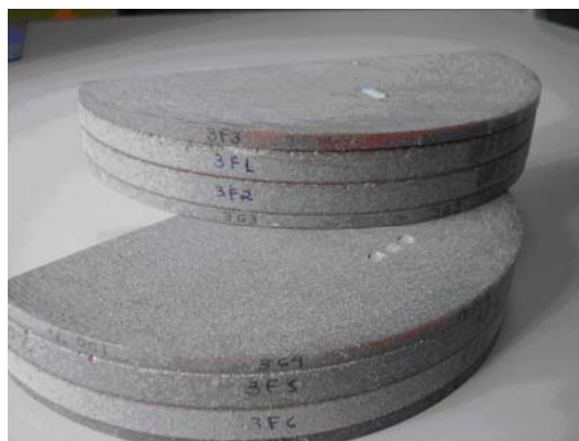
Figura III.9. Posicionamento dos TLDs na superfície e interior do fantoma
