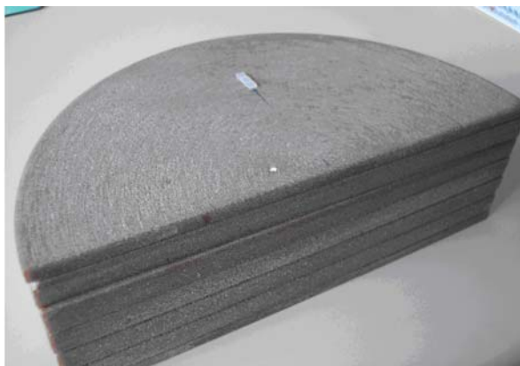
Figura III.1: Fantoma dosimétrico e dosímetros termoluminescentes na sua superfície.
