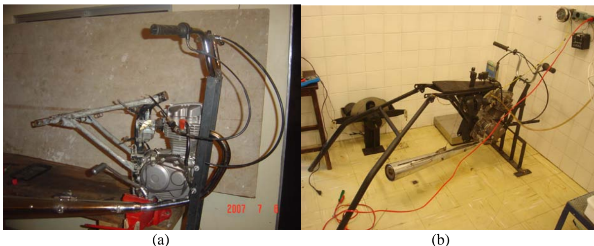
Figura 4: Aparato mecânico: (a) fixação do motor no quadro e (b) aparato fixado no assoalho do laboratório.
