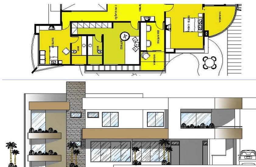
Figura 116 - Correspondência entre e planta baixa do pavimento superior e fachada lateral
