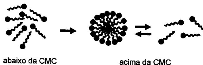
FIGURA 3: Representação esquemática da formação do agregado micelar, adaptado de [33]
