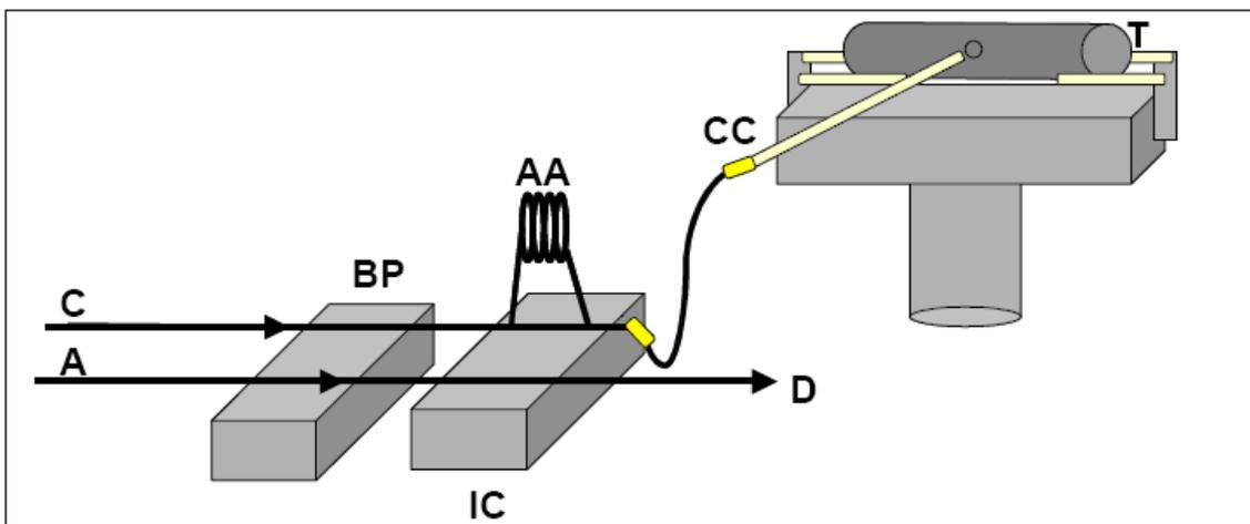
FIGURA 5: Representação esquemática do sistema TS FF AAS: **BP** – bomba peristáltica; **C** – carregador; **A** – amostra; **IC** – injetor/comutador; **AA** – alça de amostragem; **D** – descarte; **CC** – capilar cerâmico; **T** – tubo de níquel, adaptado de [56].
