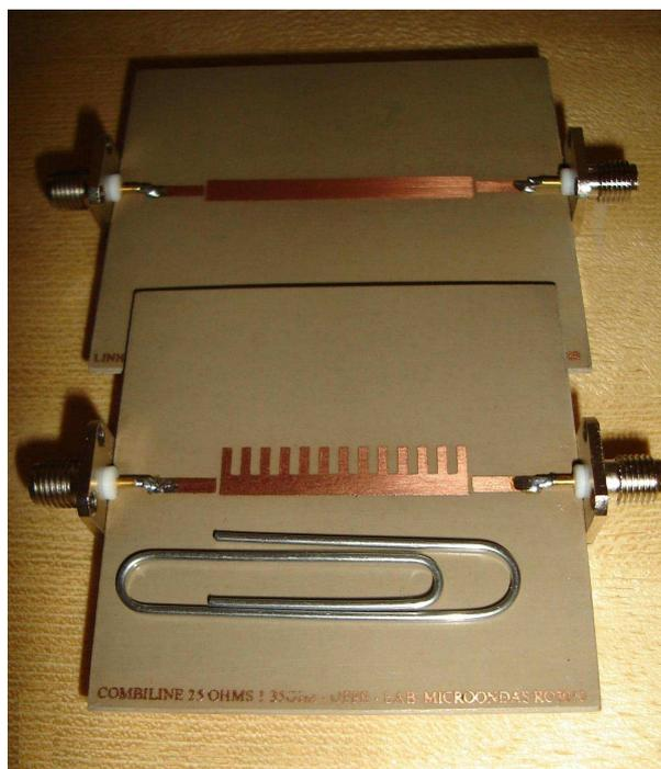
**Figura 6.7** - Ressoradores de referência e *comblin*e construídos.
