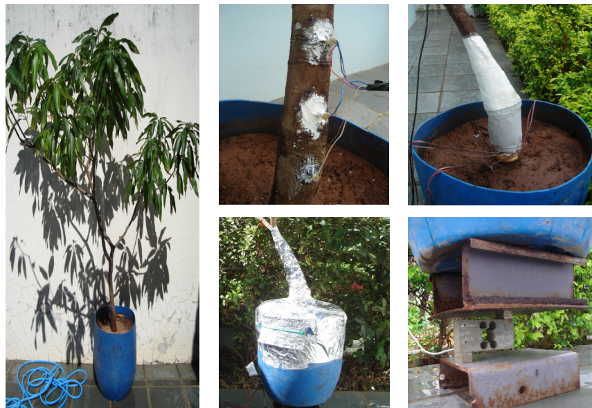
Figura 16. Montagem do lisímetro para calibração da sonda de dissipação térmica utilizada na estimativa do fluxo de seiva.
