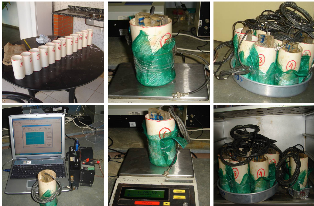
Figura 11. Seqüência de fotografias ilustrando o processo de calibração de guias de ondas utilizadas na TDR, para a determinação do teor de água do solo.
