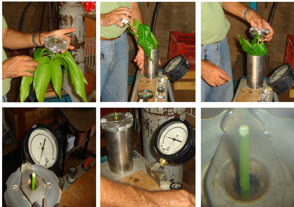
Figura 20. Sequência de fotografias ilustrando a utilização da bomba de Scholander.
