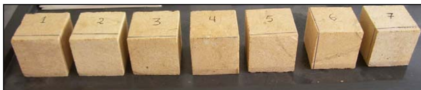
FIGURA 79. Corpos de prova do calcário Royal Dorado (RD), de caráter mais homogêneo e granulação fina.
