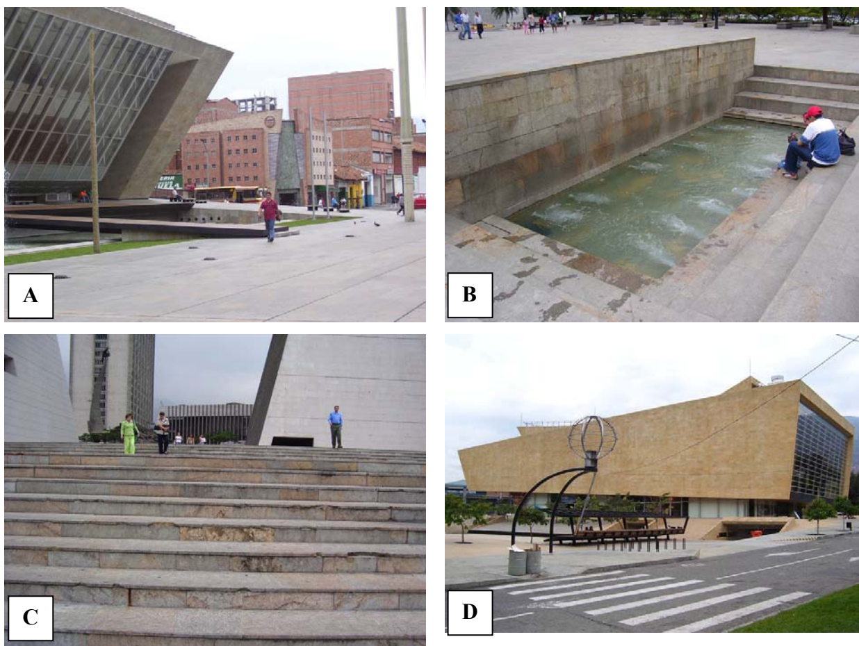
FIGURA 113. Uso dos calcários ornamentais da Formação La Tampa em Medellín. RVT como revestimento externo e piso (A) e como ornamento (B) no Parque de las luces; (C) uso dos calcários RV e RVT na escadaria do Centro administrativo La Alpujarra; D) uso do calcário RD como revestimento externo no Planetário Jesús Emilio Ramírez.
