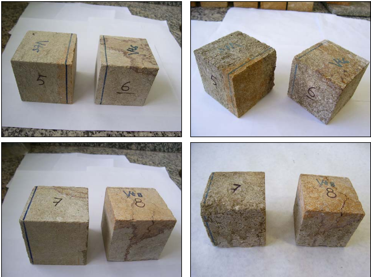
FIGURA 89. Deterioração diferenciada dos corpos de prova do calcário RVT. Esquerda: aspecto antes do início do ensaio de cristalização de sais. Direita: aspecto após oito ciclos, com predomínio da deterioração nas áreas inalteradas.
