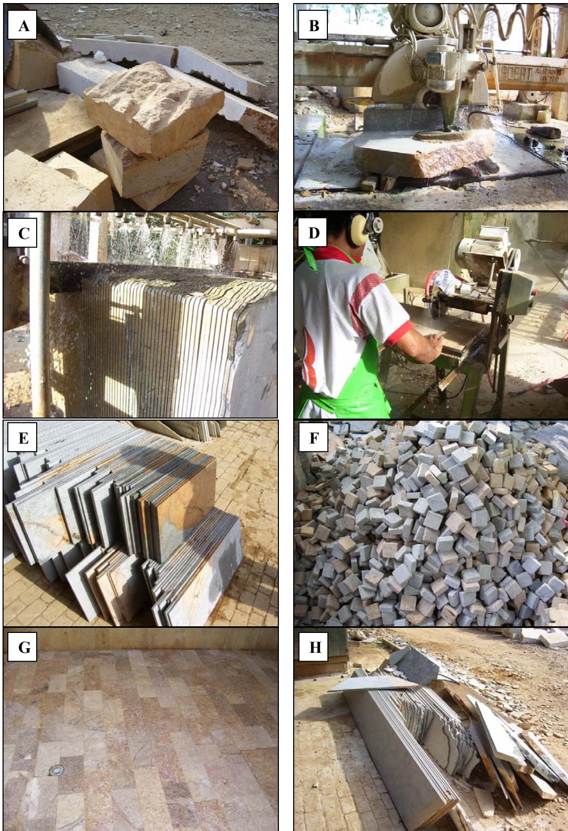
FIGURA 29. Processos de beneficiamento do calcário na mineração “Canteras de los Andes”. A) Extração de blocos brutos. B) Polimento para elaboração de tampas de mesas. C) Serragem para a obtenção de chapas para revestimento. D) Corte em chapas de diferentes dimensões. (E-H) Exemplos de variedades de chapas produzidas pela empresa Cantera de los Andes do beneficiamento do calcário da Formação La Tampa.
