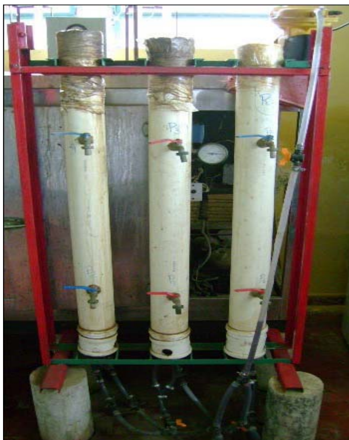
Figura 2.9. Torres empacotadas para o tratamento de líquido por stripping (LEITE et al. , 2007).
