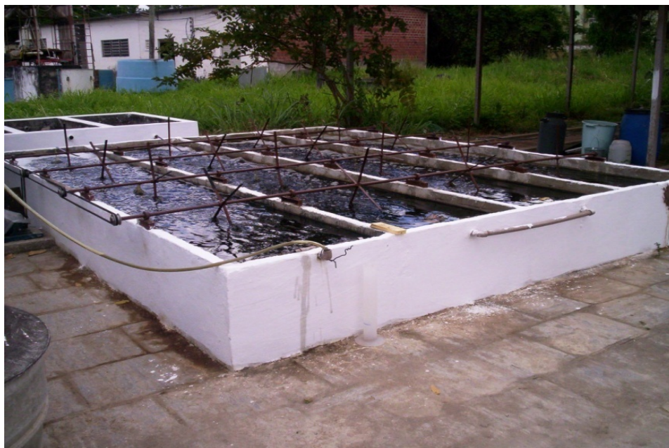
Figura 2.10. Reatores de stripping em série com o sistema de agitação (LEITE, 2007).
