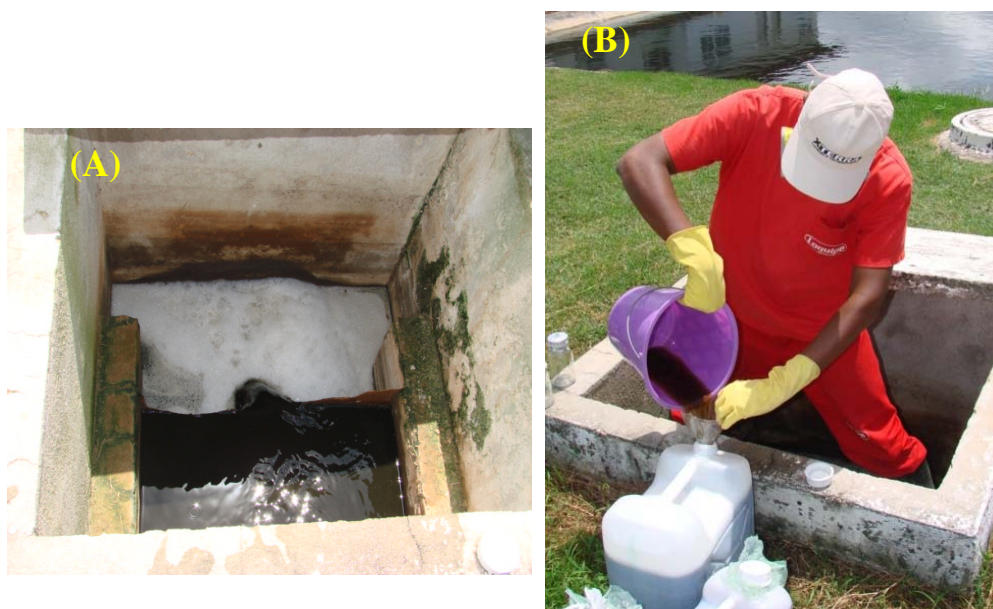
Figura 3.2. Ponto de coleta - Caixa de vazão (a) e armazenamento das amostras em recipientes de polietileno (b).
