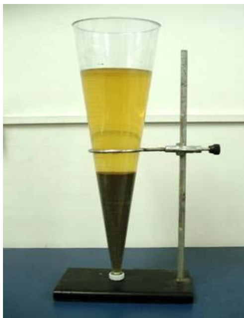
Figura 3.7. Cone de Imhoff utilizado para a determinação do volume do lodo.
