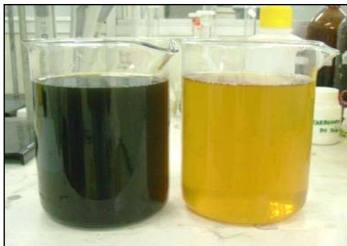
Figura 4.4. Lixiviado antes (à esquerda) e pós tratado por precipitação química com hidróxido de cálcio (à direita).
