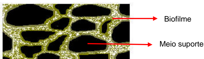
Figura 2.4. Representação esquemática do biofilme aderido ao meio suporte (Adaptado de CASAGRANDE, 2006).
