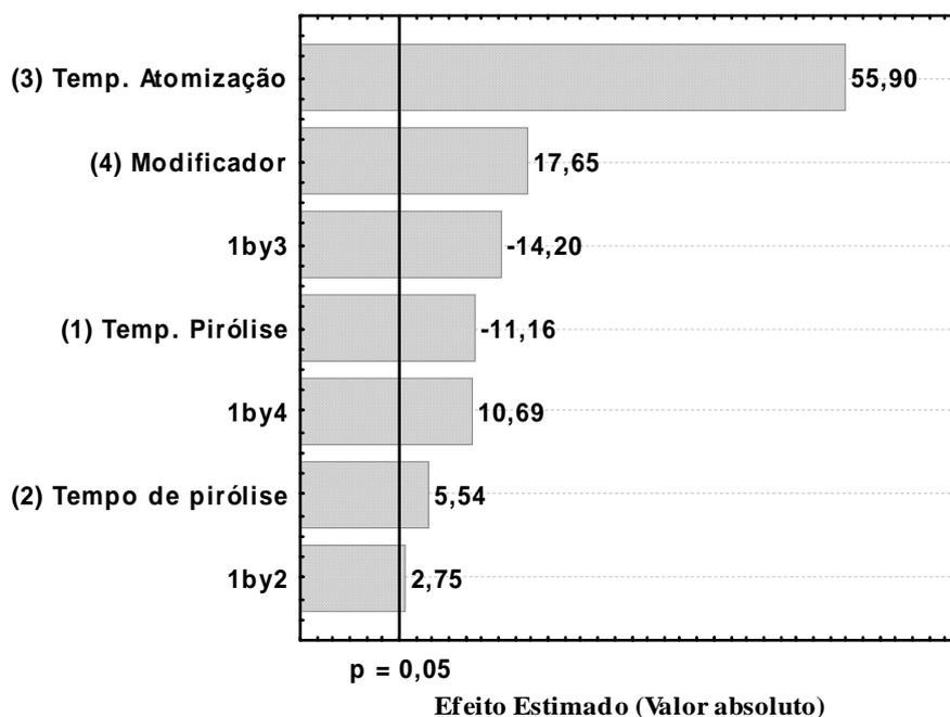
Figura 3 – Gráfico de Pareto gerado por planejamento fatorial fracionário ( $2^{4-1}$ ) utilizando MEA como diluente na análise de Mn (coeficiente de ajuste do modelo  $R = 0,9942$ ).
