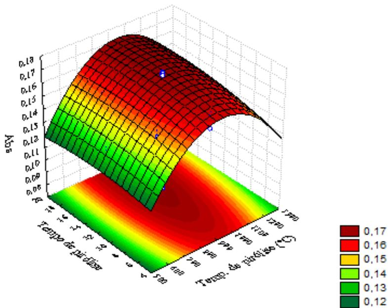
Figura 26 - Superfície de resposta gerada por planejamento composto central para otimização das variáveis temperaturas e tempo de pirólise e atomização utilizando TRIS como diluente na análise de Pb.
