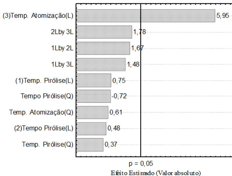
Figura 5 - Gráfico de Pareto gerado pelo planejamento composto central utilizando MEA como diluente na análise de Mn (L e Q referem-se aos termos lineares e quadráticos do modelo gerado).
