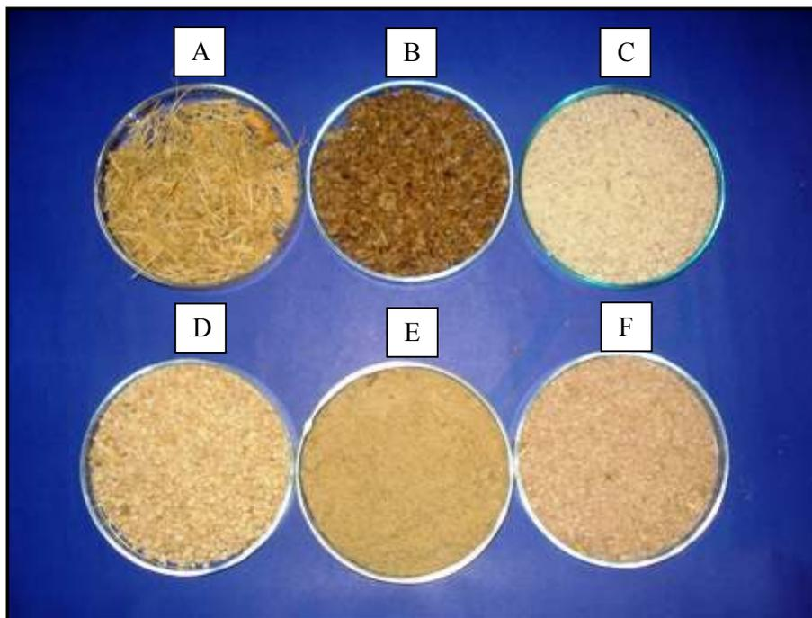
Figura 3.2: Substratos base e suplementos utilizado nos ensaios. A) Bainhas medianas; B) Bagaço de malte; C) Bagaço de mandioca; D) Farelo de soja; E) Farelo de trigo e F) Farelo de arroz.
