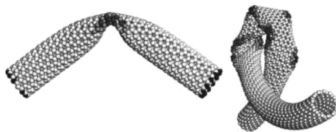
FIGURA 2.8. Simulações mostrando duas possíveis deformações sofridas nos nanotubos sem ruptura das estruturas, indicando alta flexibilidade desses materiais (AJAYAN, 1999).
